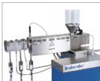
Измерительный экструдер/ Extrusiograph 19/25 Применение: Термопласты
