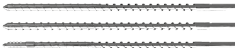
Примеры шнеков (сверху вниз): 4:1 3-зонный шнек, 4:1 шнек с постоянным шагом и уменьшающейся глубиной, 4:1 диспергирующий шнек с Maddock и смесительным сегментом
