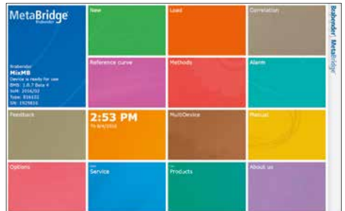
Durch Mouse-Klick oder Touch kann der Bediener eine der farblich voneinander leicht zu unterscheidenden Kacheln auswählen.
