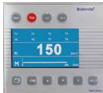
Панель управления для установки заданных значений и отображения фактических значений
