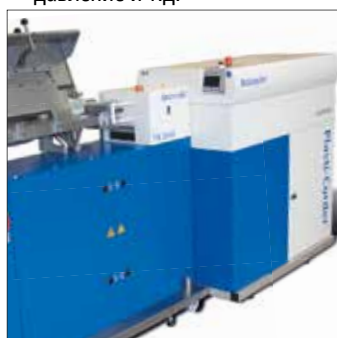
Plasti-Corder Lab-Station с двухшнековым экструдером TSE 20/40
